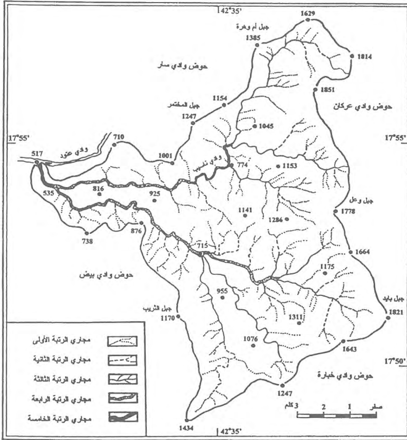
الشكل - 8 - الترتيب الهرمي للمجري المائية لحوض وادي ناسيب حسب طريقة سترابيل Strahler
