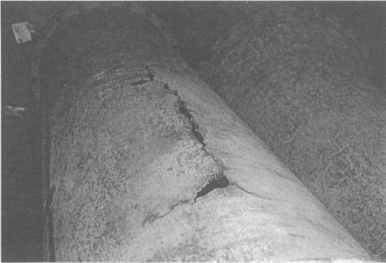
الشكل (٤) شقوق التآكل الإجهادي في عمود التصريف لمضخة الدوار الملحي
